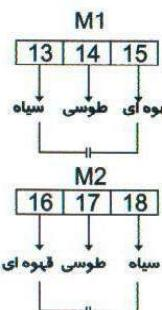
**موتور راست (M2) :** اگر موتور را به گونه ای قرار دهید که برآمدگی موتور جک رو به پانین و بازوی جک به طرف راست باز شود میان موتور راست نامیده می شود که سیم بندی آن به ترتیب اینها مطابق شکل زیر است .
