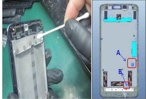
2、使用棉棒或硅胶棒，在前壳组件背面底部的通孔处将 LCD 顶出，注意：轻轻的顶出，不能用较大的力，如果不能顶出，必须再次继续对背胶区域进行烘烤，以降低背胶粘性，以便顺利顶出 LCD。顶 A 位置时上部导电布会裂开，顶 B 位置时下部胶纸会裂开。
