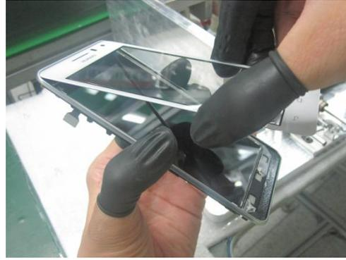
8、将吸盘把手掀起，并将吸盘脱落 TP 表面，然后将吸盘整体推移，避开前壳组件；取出前壳组件，将软质细条状物料拔出，同时从 TP 底部将 TP 慢慢掀起，直至 TP 完全与 A 壳分离，确保 TP FPC 无破损
