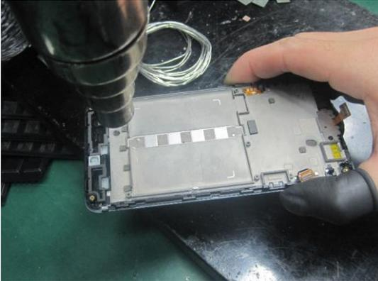
1、使用热吹风机，对 A 壳组件底部和顶部的 LCD 背胶区域进行均有烘烤。在吹的时候移动风枪，避免长时间集中吹一个位置。热风枪温度设定  $75 \pm 5 \text{ }^{\circ}\text{C}$ ，吹风距离 3 厘米。吹风时间：10 分钟（主要对前壳 4 周背胶位置）
