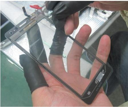
9、使用保护膜将 TP 内表面和 LCD 覆盖保护，避免灰尘污染和表面磨损擦伤。TP 拆卸完成。
