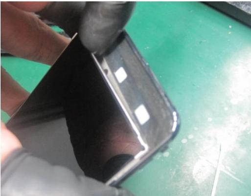
3、用棉棒或者硅胶棒将 LCD 顶起后，请务必使用平板尺子物体探入 LCD 底部，将 LCD 平稳掀起
